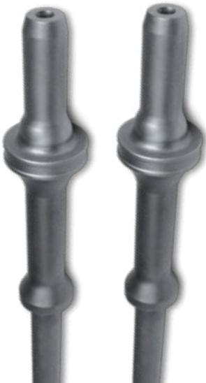
Pieza de acero AISI/SAE 1045 O AISI/SAE 4140 obtenida por maquinado a partir de una barra redonda lisa, con posterior tratamiento térmico de temple y revenido, la cual permite la instalación de los pernos Splitbolt® en los proyectos mineros y civiles, utilizando los equipos de perforación.
